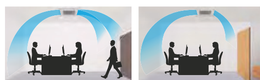
Alto nível de conforto, evitando o fluxo de ar frio direto sobre as pessoas.
