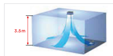
Modo "High Ceiling". Permite a instalação em tetos com altura até 3,5 m.
